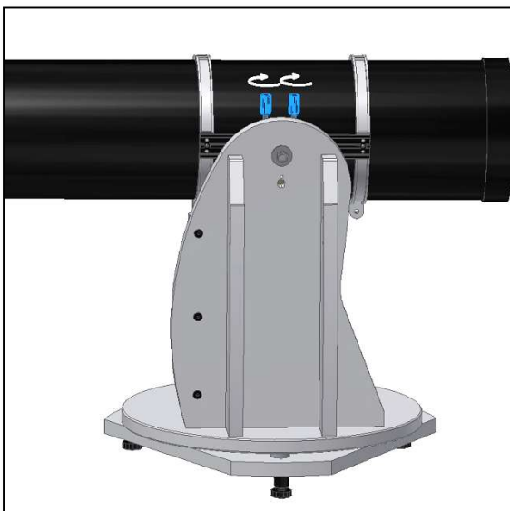
Abb 18. Den Schwalbenschwanz des Teleskops einschieben und die beiden Knöpfe fest anziehen.
